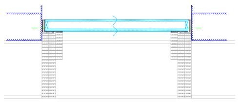
Horizontale Brandschutzverglasungen unter dem Glasboden im Gastraum: Schnitt horizontal quer Zeichnungen: MB Fensterbau & Tischlerei
