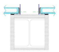
Horizontale Brandschutzverglasungen unter dem Glasboden im Gastraum: Schnitt horizontal längs
