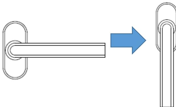
Fenstergriff von geschlossener Stellung über die waagerechte Stellung in die Kippstellung bewegen → Federkraft der Rückstellung sollte Fenstergriff zurück in waagerechte Stellung bringen
