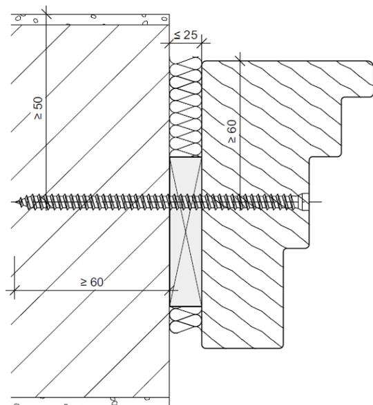
Wandanschluss über Seitenteile, mit Koppelung zum Fensterrahmen
