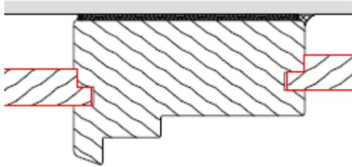
Verleistung/ Profile zum Fensterrahmen bzw. Abdecken der Bauanschlussfuge
