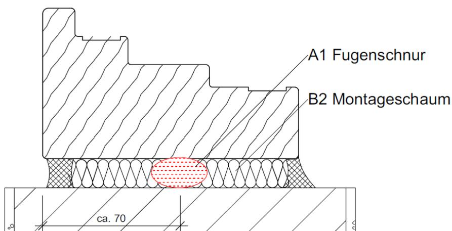
1. Innenseitig dauerelastische Versiegelung mind. „normal entflammbar“ (B2 nach DIN 4102-1 bzw. D/E nach DIN EN 13501-1)
