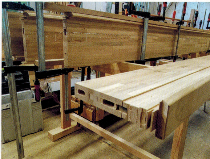
Fertigung der Holzsäulen für einen Schulneubau in Frankfurt am Main.
